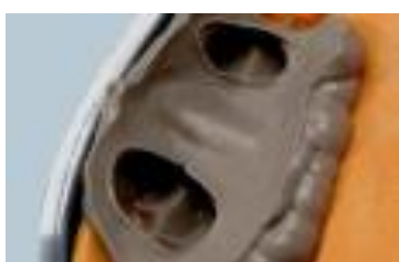
Mauvaise liaison entre le plateau et le matériau de lavage, probablement causée par un temps de travail dépassé
